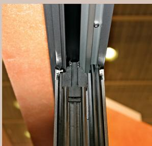
Anders als bei Hebe-Schiebetüren wird nicht mit grossem Hebel und viel Kraft der ganze Flügel angehoben bzw. abgesenkt um die Abdichtung in Stellung zu bringen: ein kleiner Griff genügt um beim Schliessen die Extender-Dichtung auszufahren.
